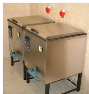
Грязевой котел с перемешивающим устройством
